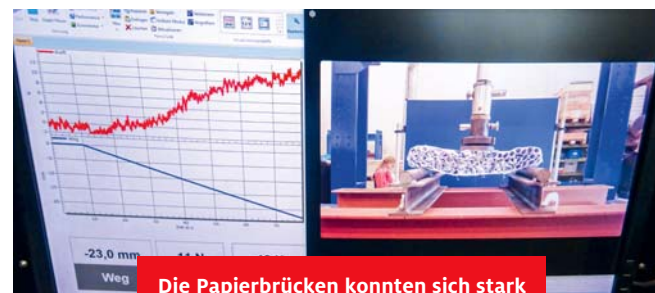
Die Papierbrücken konnten sich stark verformen, bevor sie rissen
